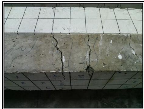
Retakan Pada Pengujian Balok
