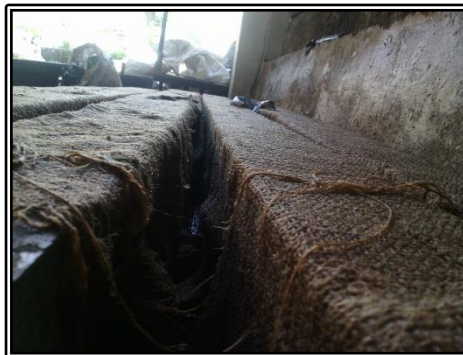
Perawatan Benda Uji Balok
