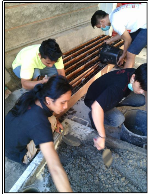
Pembuatan Balok & Silinder Beton
