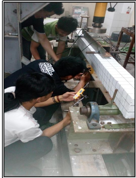
Setting Dial Gauge Pada Balok
