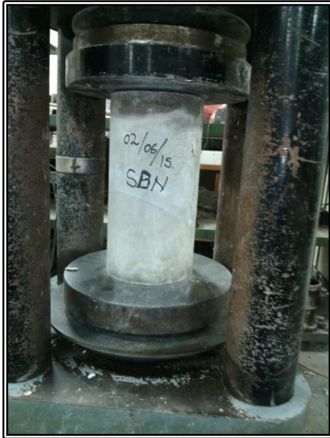
Pengujian Kuat Tekan Silinder Beton
