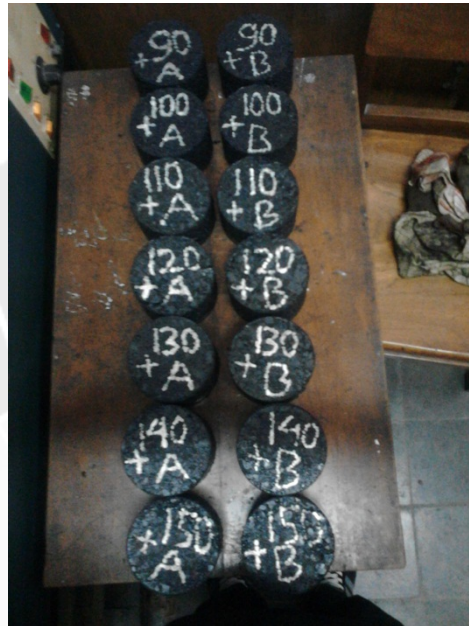
14 Benda uji dengan variasi suhu pada proses pemadatan aspal beton
