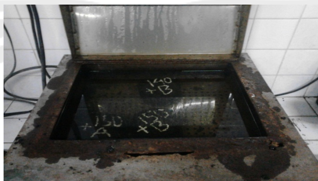
Benda uji direndam dalam waterbath sebelum diuji Marshall
