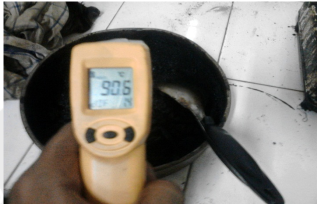
Pengukuran suhu sebelum dipadatkan menggunakan thermogun
