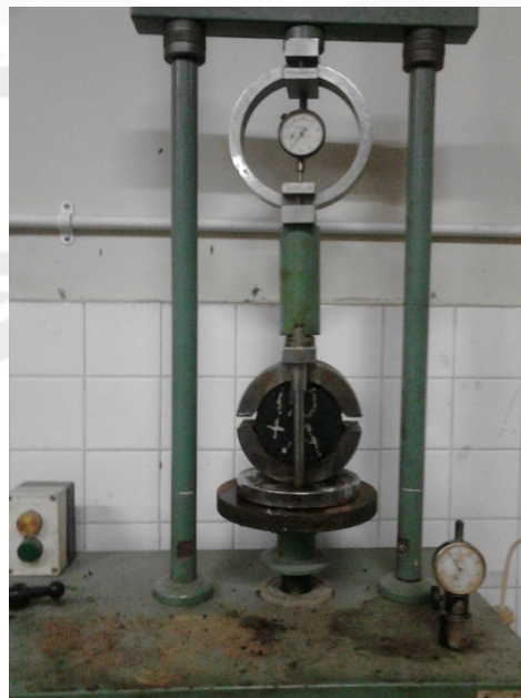
Pengujian Marshall terhadap benda uji
