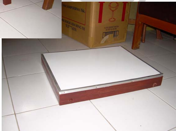
Meja Kerja Lipat untuk Proses Pengeleman (baru) yang sudah disesuaikan dengan kaidah antropometri pekerja
