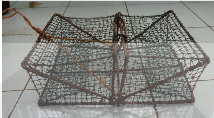
Gambar 3. Alat tangkap (bintur) Keong Macan di Pantai Gesing Yogyakarta bentuk persegi, yang dapat dibuka di bagian tengah.
