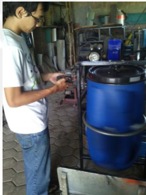
Pengambilan data kecepatan turbin menggunakan tachometer
