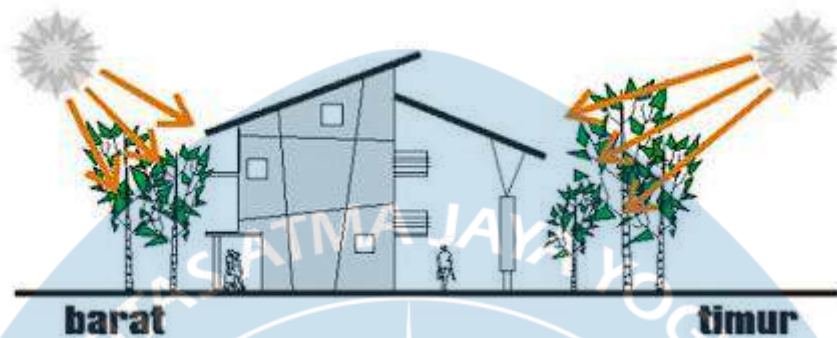
Gambar 2.6-2 Pengaruh vegetasi terhadap penyerapan solar heat gain (Sumber: Moerni, 2024)
