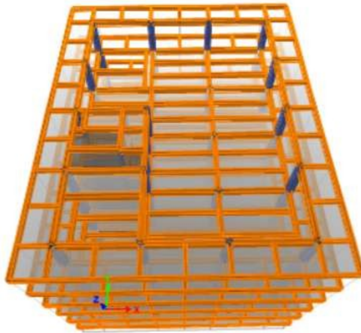
Gambar 2.6 Pemodelan struktur tampak atas Struktur dirancang menggunakan sistem rangka pemikul momen khusus (SRPMK). Material struktur yang digunakan yaitu : - Beton : f_c' 25 \text{ MPa}
