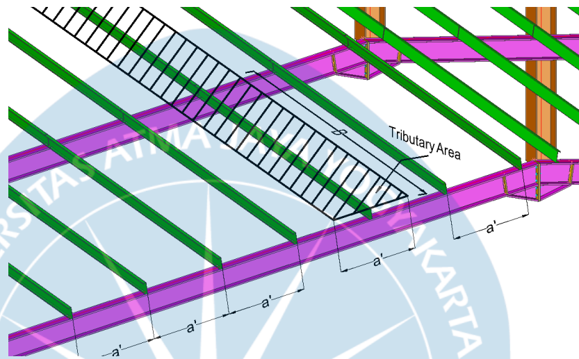
Gambar 2.1.1 Tributary Area Beban yang Bekerja pada Gording
