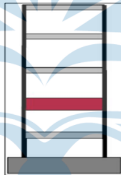
Gambar 2. 28 Ketidakberaturan Vertikal Tipe 2
