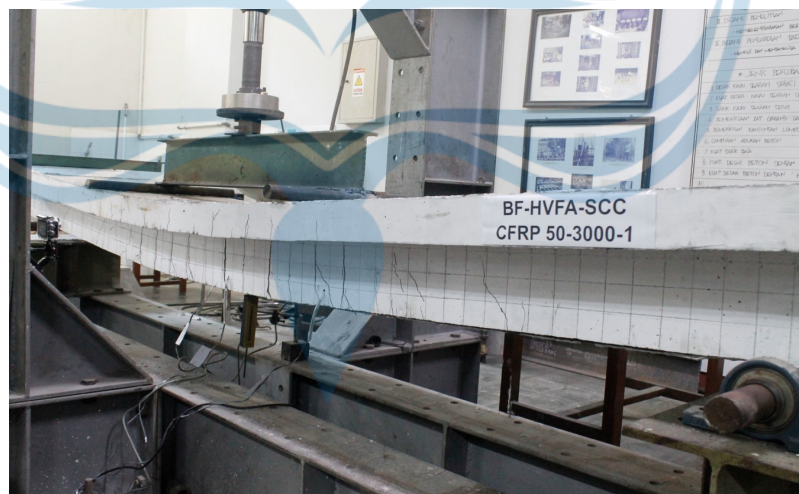
Gambar 5 28. Benda uji balok dengan perkuatan CFRP (BF-HVFA-SCC-CFRP50-3000-1) sebelum diberikan Pembebanan
