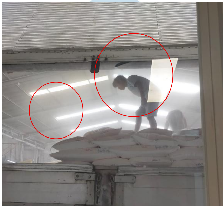
Gambar 1.5. Udara yang Mengandung Debu Halus, Posisi Tubuh saat Mengangkat Beban Membungkuk, dan Tidak Menggunakan Masker, Sarung Tangan, serta Sepatu.
