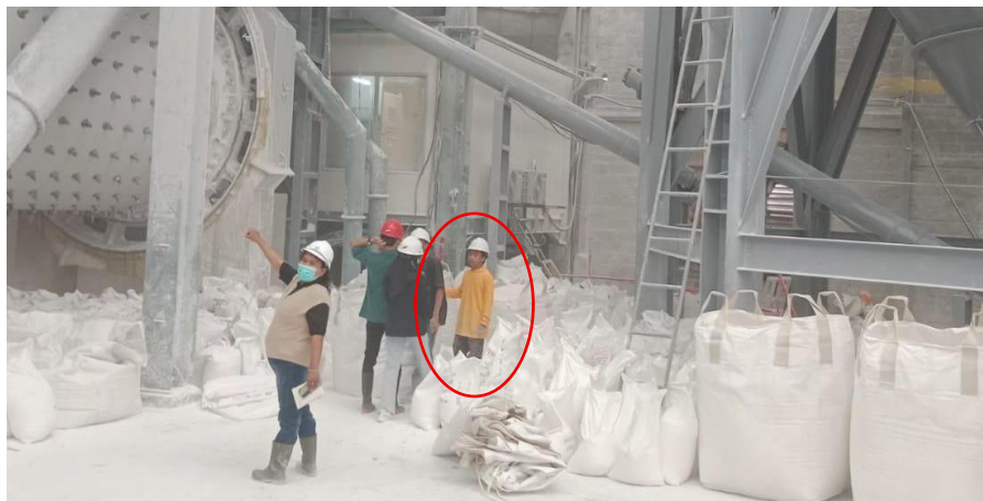
Gambar 1.2. Pekerja Tidak Menggunakan APD (Masker)
