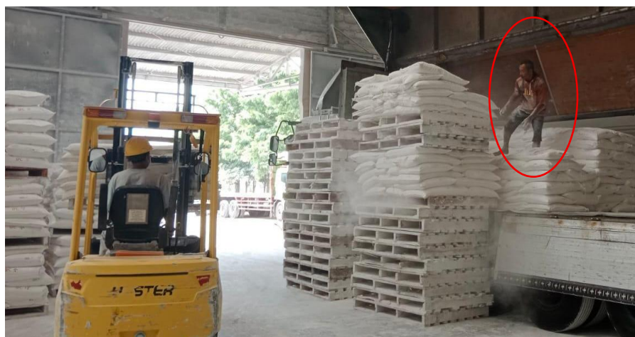
Gambar 1.3. Pekerja Tidak Menggunakan APD (Masker, Helm, Sepatu) dan Posisi Tubuh Saat Mengangkat Beban Membungkuk
