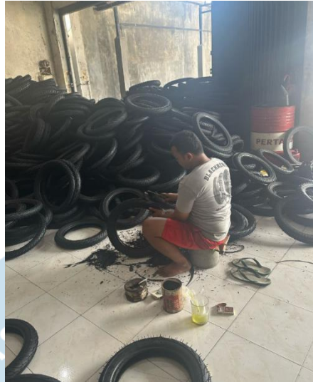
Gambar 1.3. Proses mengerok ban
