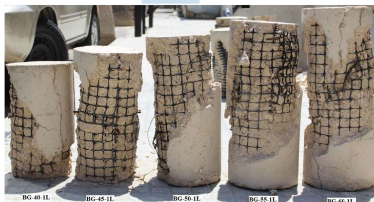
Gambar 2. 1 Hasil Pengujian Spesimen Kolom Silinder Geogrid Biaksial (Sumber : (Daou et al., 2020))
