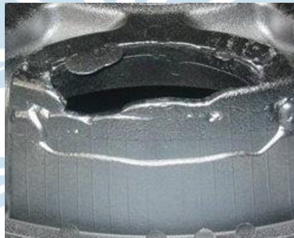
Gambar 2.3. Contoh Cacat Mis-run
