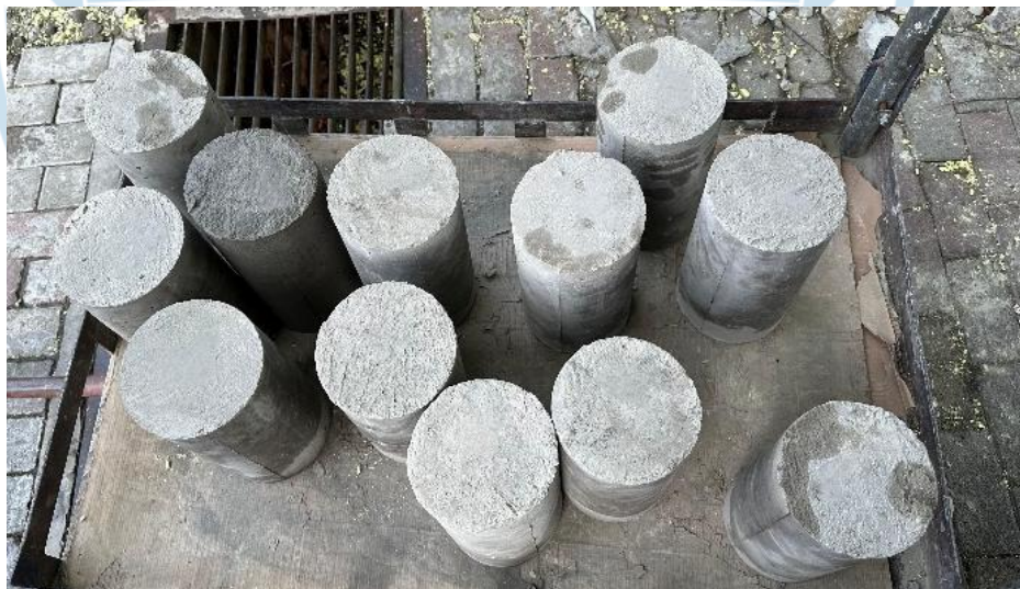
Lampiran 8 Setelah Curing beton Siliner Beton Normal dan Beton Self Healing Dosis 0,01%,0,10%dan 1% selama 28 hari
