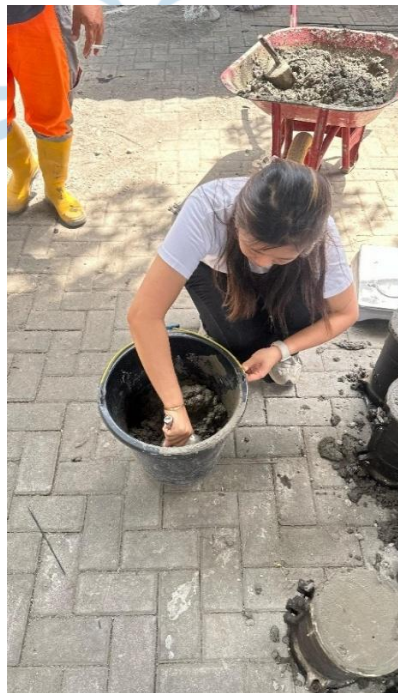
Lampiran 4 Campuran Beton dan Bakteri Bacillus Subtilis dicampurkan secara merata
