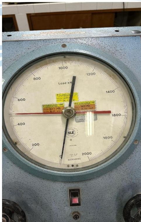
Lampiran 10 Pembacaan Pengujian Nilai Kuat Tekan dengan Mesin CTM ( Compression Testing Machine )
