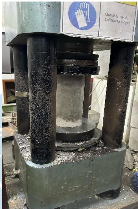
Lampiran 9 Pengujian Kuat Tekan Beton Menggunakan Mesin CTM ( Compression Testing Machine )
