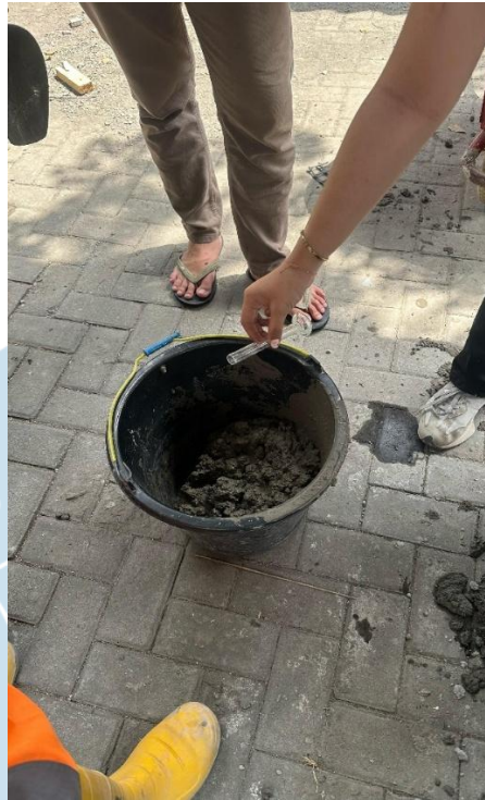
Lampiran 3 Bakteri Bacillus subtilis dicampurkan ke dalam adukan beton yang sudah diukur sesuai volume satu cetakan silinder, dengan tiga variasi dosis yaitu 0,01%, 0,10%, dan 1%
