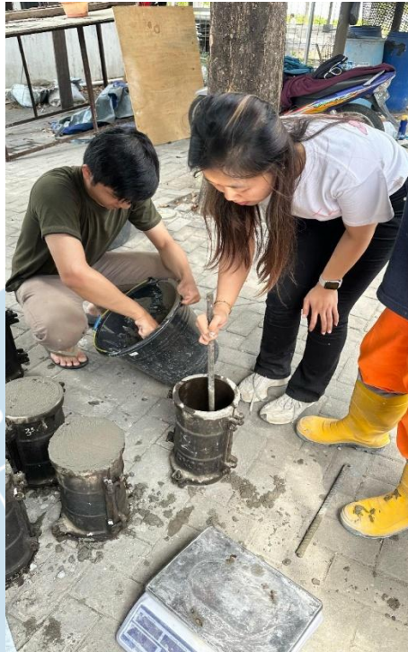
Lampiran 5 Proses Pembuatan Benda Uji Silinder Beton
