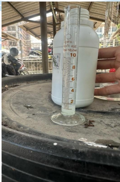
Lampiran 2 Bakteri Bacillus Subtilis diukur dengan gelas ukur dan di bagi menjadi 3 dosis, yakni 0,01%; 0,10%; dan 1 % terhadap cetakan silinder
