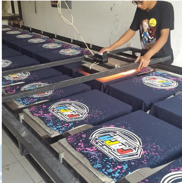
Lampiran 5. Pekerjaan Pengeringan Kain
