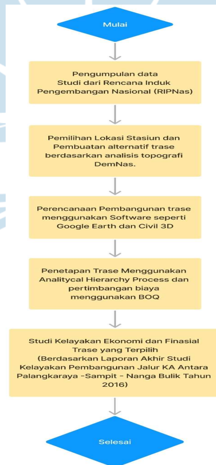
Gambar 1. 1 Alur Perencanaan Pembangunan Jalur Kereta Api
