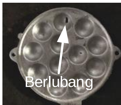
Gambar 1.10. Produk Cetakan Kue Berlubang
