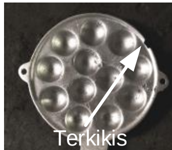
Gambar 1.11. Bagian Produk Cetakan Kue Terkikis
