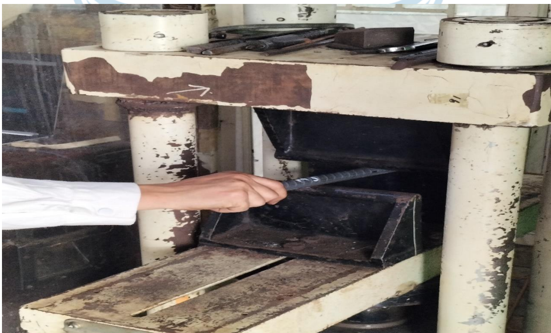
Pekerjaan pengetesan material besi
