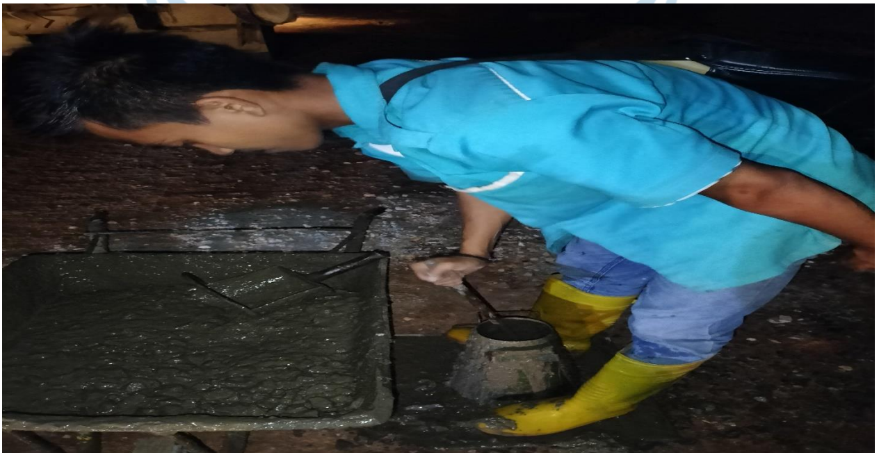
Pengecekan nilai slump beton
