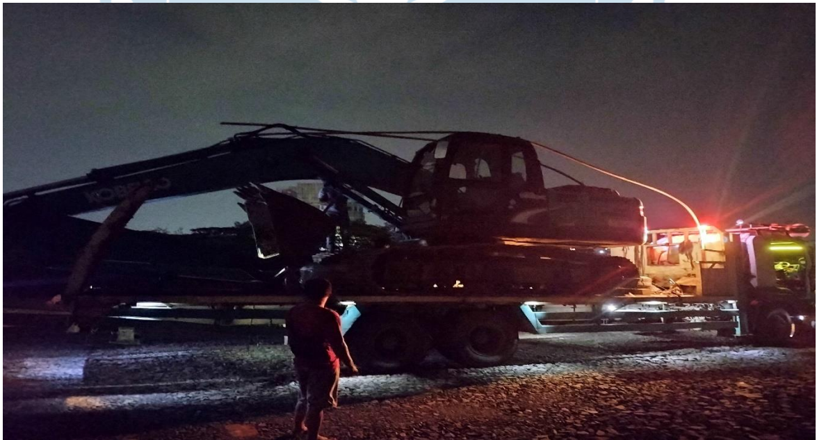
Mobilisasi unit excavator
