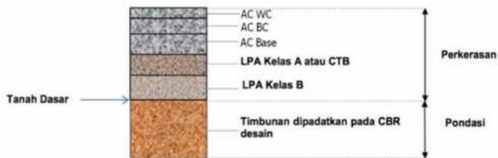
Gambar 2.2. Struktur Perkerasan Lentur pada Timbunan
