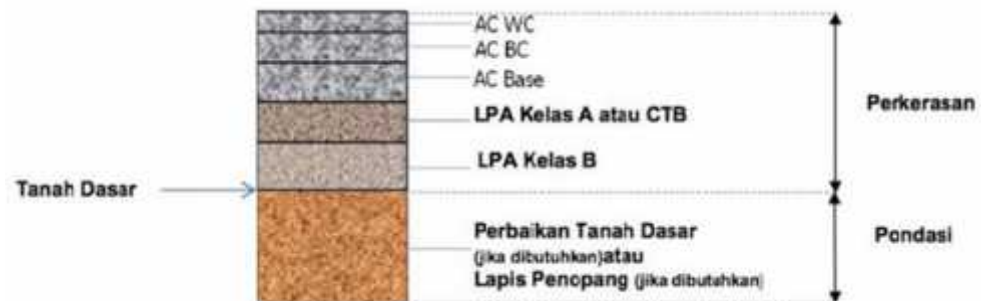
Gambar 2.1. Struktur Perkerasan Lentur pada Permukaan Tanah Asli
