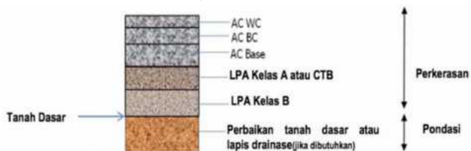
Gambar 2.3. Struktur Perkerasan Lentur pada Galian
