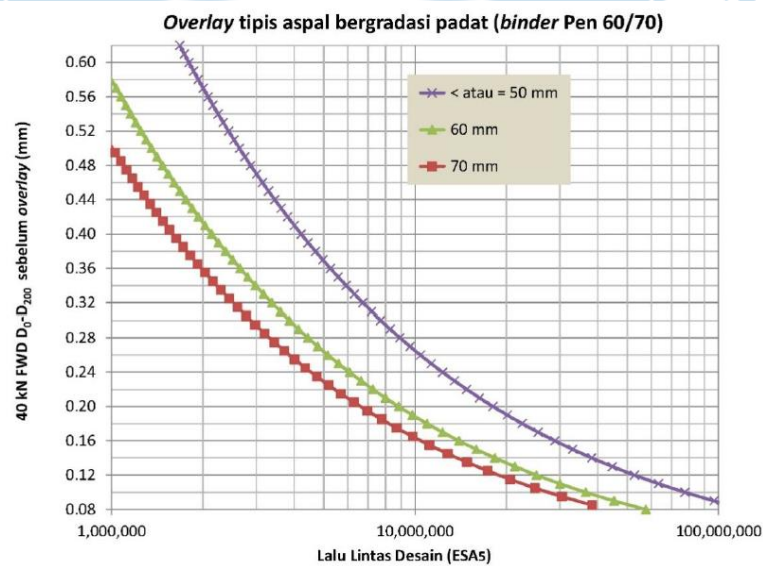
Gambar 3.4 Tebal Overlay tebal Aspal Konvensional Untuk Mencegah Retak Akibat Lelah
