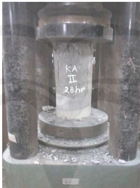
Silinder Beton S8-II (28 Hari)
