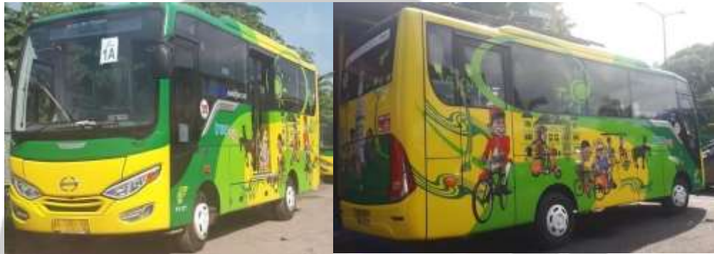
Gambar 5.4. Bus Hino Fb 130 Karoseri Restu Ibu Pusaka Kapasitas 30 Penumpang (Sumber : Hasil Survey)
