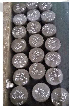
Perawatan Benda Uji
