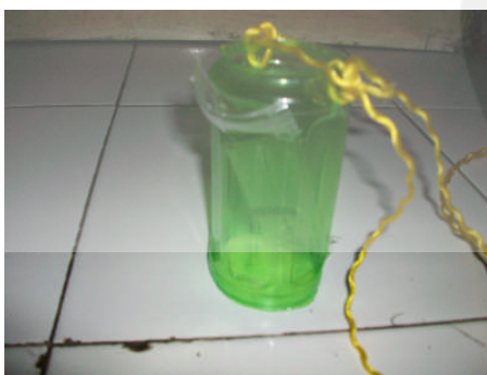
Gambar 30. Perangkap biofilm Mikrobentos, tampak samping
