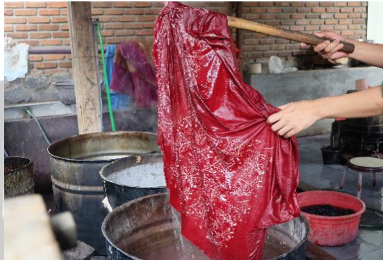
Gambar 2.5 Proses Nglorod dalam Membatik
