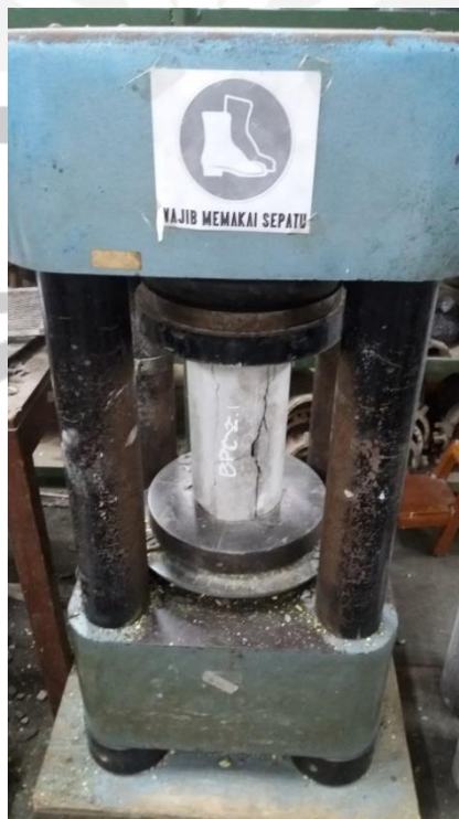
Gambar 13. Pengujian Kuat Tekan Beton
