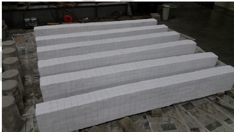
Gambar 9. Pembuatan Grid Balok
