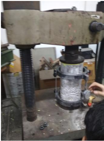
Pengujian modulus elastisitas beton
