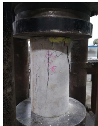
Pengujian kuat tekan beton
