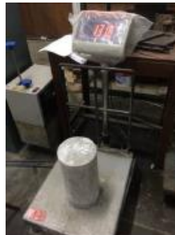
Penimbangan berat beton
