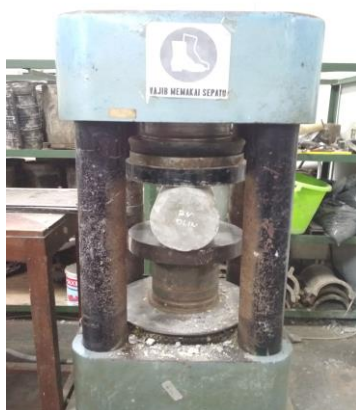
Pengujian kuat tarik belah beton
