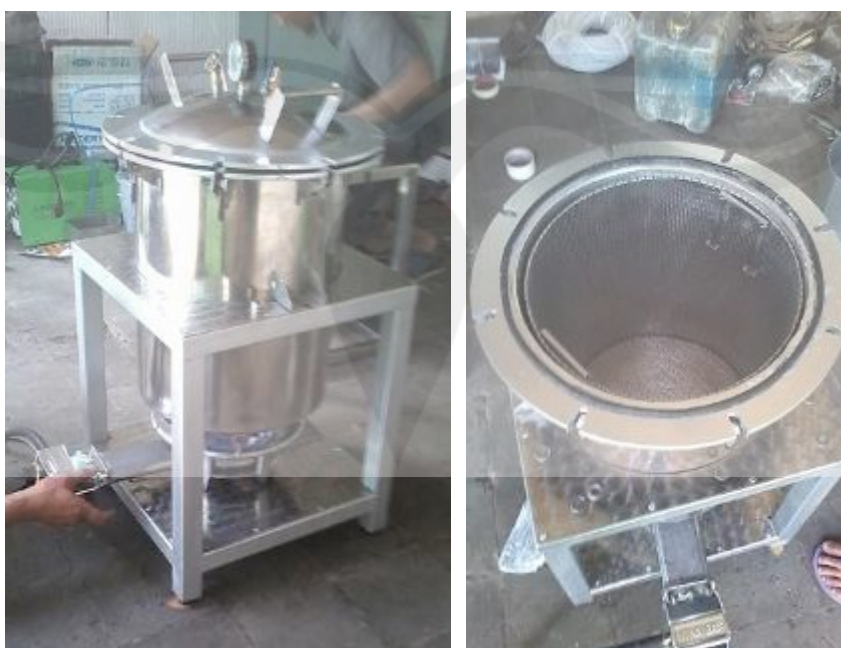
Gambar 5.8. Instalasi mesin sterilizer
