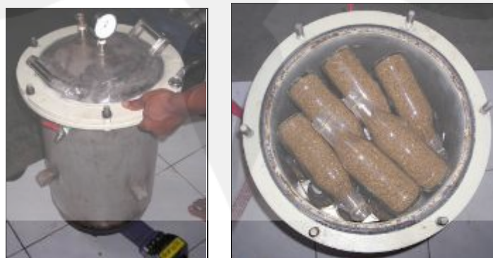
Gambar 3.2. Teknologi mesin sterilisasi untuk industri jamur tiram. Karat mudah muncul pada tabung bagian dalam.
